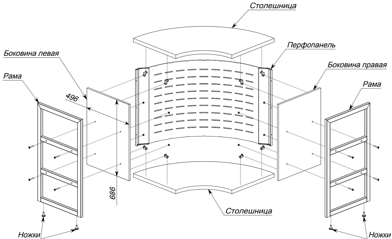
1. Собрать короб из боковин и столешниц, используя уголки с винтами
